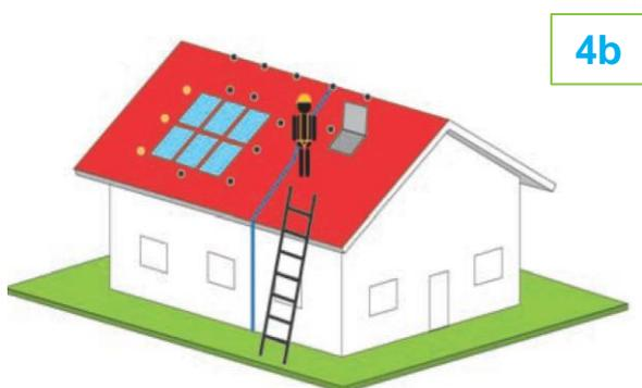
Nel caso l'altezza della linea di gronda sia inferiore a 5,5m, non si potrà installare la linea di vita ma si potranno utilizzare solamente punti di ancoraggio. In questo caso i punti di ancoraggio (del tipo EN 795) si disporranno lungo la linea di colmo (fig.4b).
